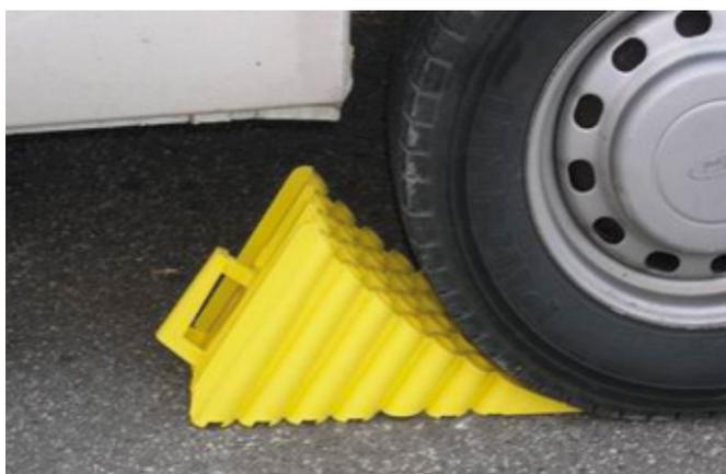
Si è autorizzati a porre cunei sotto le ruote solo se il veicolo è in sosta in una discesa e/o in una salita
